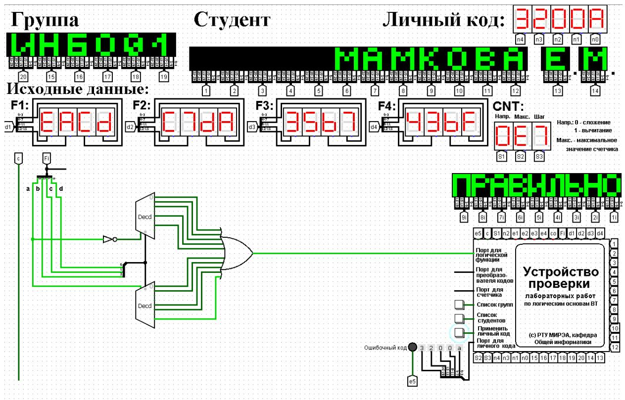
Рис.3 Тестирование схемы, реализующей логическую функцию на дешифраторах 3-8 и дополнительной логике
