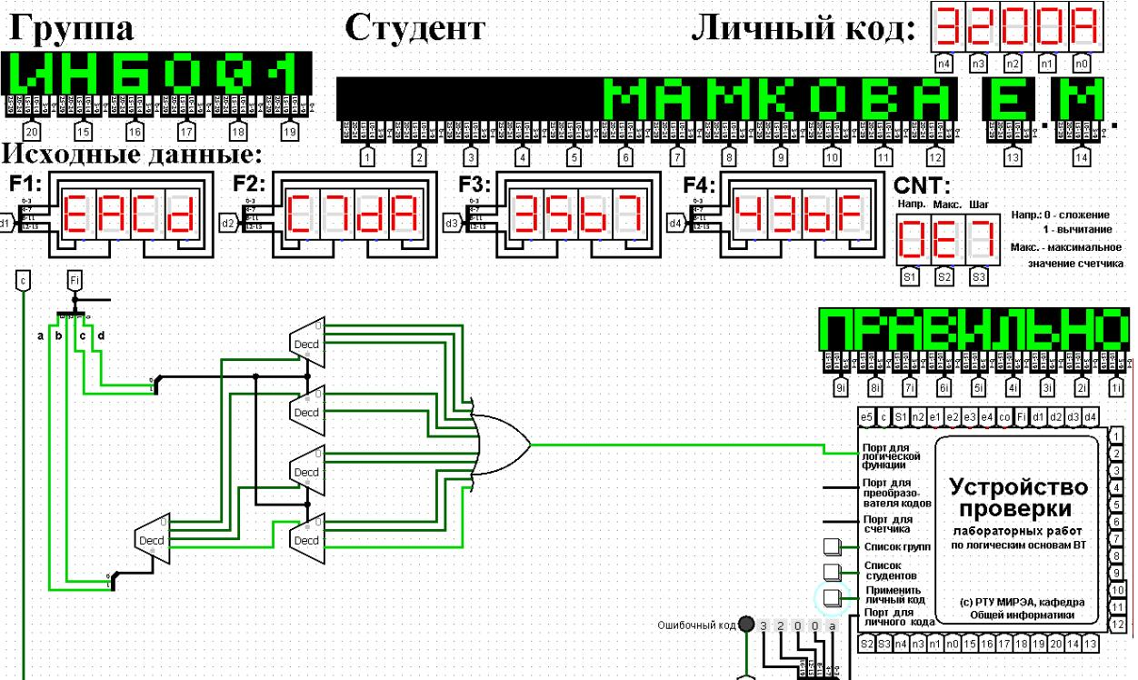
Рис.5 Тестирование схемы, реализующей логическую функцию на дешифраторах 2-4 и дополнительной логике
